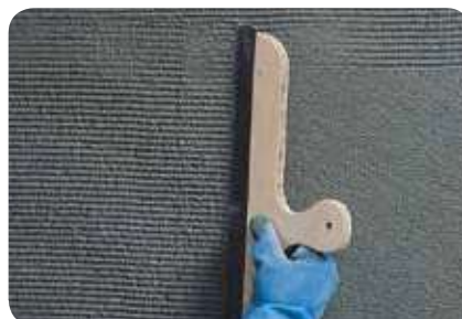
5. Zum Entfernen der Sinterhaut wird ein Flächenspachtel, gezahnt , benötigt.
