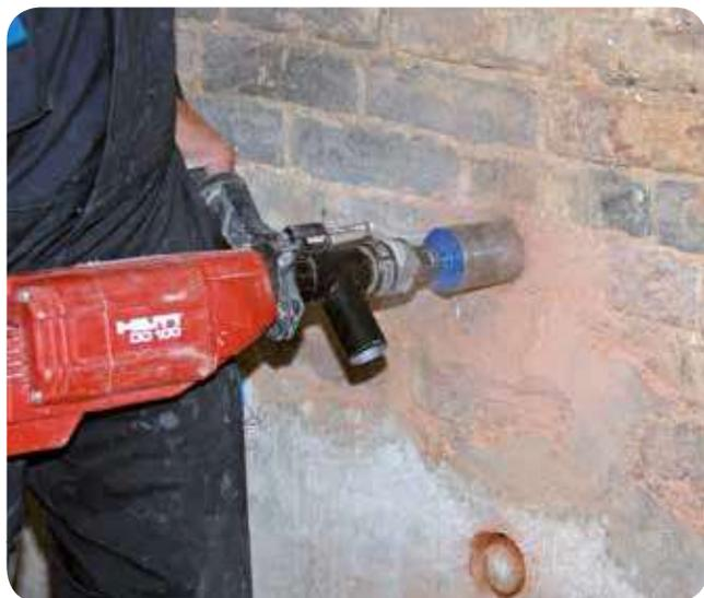
Probenahme von feuchte- und salzbelastetem Mauerwerk.
