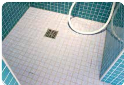
Die Duschwannenelemente können in jedem beliebigem Format geliefert werden. Der Abfluss kann, mit einem Mindest-Achsabstand zum Rand von 25 cm, frei positioniert werden. Die Abflussleistung von 0,8 l/sec ist in der Regel ausreichend auch für Schwallduschen.
