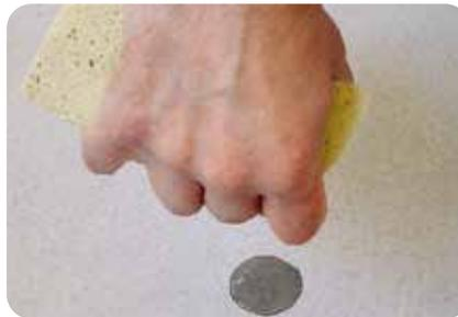
1. Der Untergrund wird mit Wasser beträufelt. Wird das Wasser sehr schnell aufgesogen, so ist der Untergrund zu stark saugend. Durch den Einsatz der geeigneten Grundierung kann das Saugverhalten gemindert werden.
