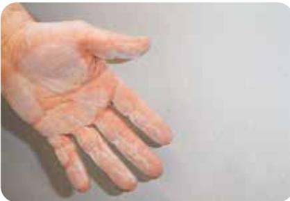
1. Man wischt mit einem trockenen Tuch oder mit der Hand über die Oberfläche. Verbleiben Rückstände von Staub oder anderen losen Bestandteilen, so sind diese zu entfernen.
