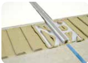
1. Die Fugenbreiten sollten durch die immer kleiner werdenden Fugenteile im Belag nicht unterdimensioniert sein und die Breite im gesamten Querschnitt von 3 mm nicht unterschreiten. Bewegungsfugen können ggf. aus optischen Gründen mit entsprechenden Fugendehnprofilen ausgebildet werden.
