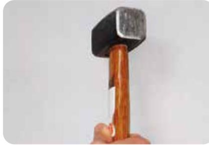
1. Ob Schalen- und Schichtenbildung im Verlegeuntergrund (z.B. Estrich) vorhanden sind, ist mit der Hammerschlagprüfung zu erkennen. Mit einem stumpfen Hammer wird in einem Winkel von ca. 45° auf die Oberfläche geschlagen.
