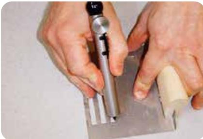
1. Mit einem spitzen Stahlnagel oder einem speziellen Ritzgerät (Ri-Ri-Gerät) ritzt man mehrere Linien in einem Abstand von ca. 6 mm parallel nebeneinander ein.
