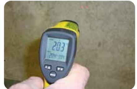
3. Bevor Epoxidharzmaterialien auf den Untergrund aufgetragen werden, ist die Oberflächentemperatur zu ermitteln. Die Oberflächentemperatur muss über der Taupunkttemperatur liegen.
