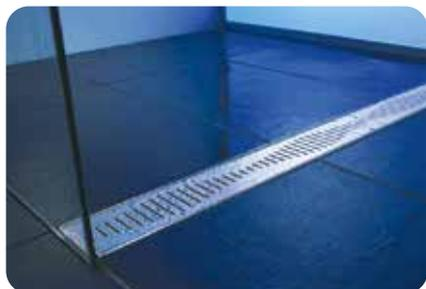
Bei Duschwannenelemente mit Rinne kann die Länge der Rinne frei in Stufen von 10 cm gewählt werden. Der seitliche Abstand zum Rand beträgt mindestens 5 cm, damit die Dichtbänder sicher angeschlossen werden können.
