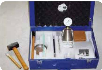
1. Die Belegreife des Untergrundes ist abhängig von seiner Restfeuchte. Zur Ermittlung von Restfeuchte in Untergründen ist der Einsatz von speziellen CM-Messgeräten zu empfehlen. Dabei ist die Gebrauchsanweisung des jeweiligen Geräteherstellers zu beachten.
