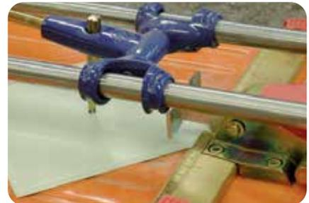
5. Das Schneiden der Glasfliesen erfolgt mit Diamant- bzw. Glasschneidewerkzeug auf der Glassseite. Alle geschnittenen Kanten sind zu schleifen.')
