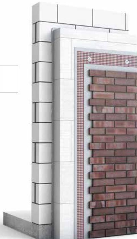
Optimal geeignet zur Kombination von Klinkerriemchen und hochwertigen Fassadenputzen.
