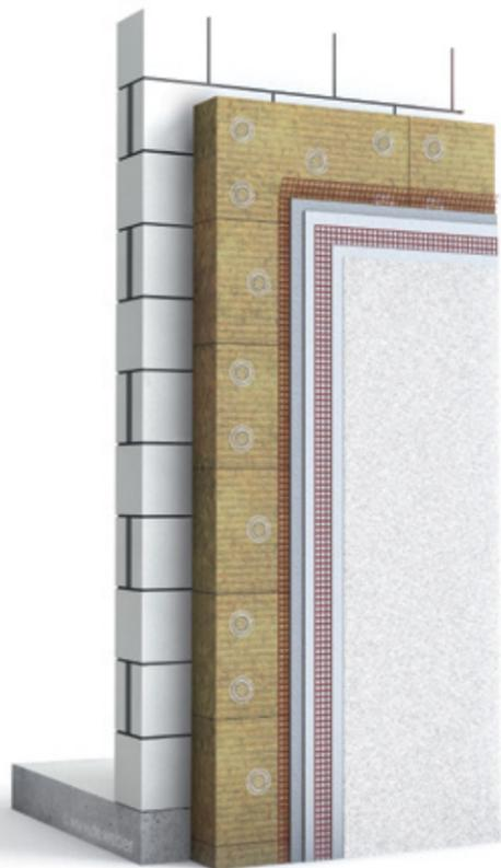
Das neuartige, bauaufsichtlich zugelassene Wärmedämm-Verbundsystem wurde mit dem Bundespreis Ecodesign ausgezeichnet und mit dem Umwelt-Siegel „Blauer Engel“ zertifiziert. Das vollmineralische System wird nur in Verbindung mit algizidfreien Oberputzen angeboten.
