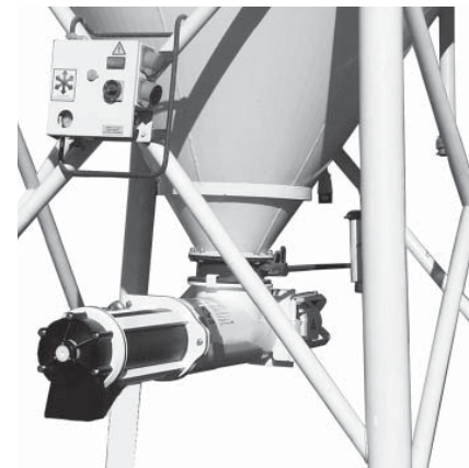
Bild 10: Schaltschrank mit Hängebügel
