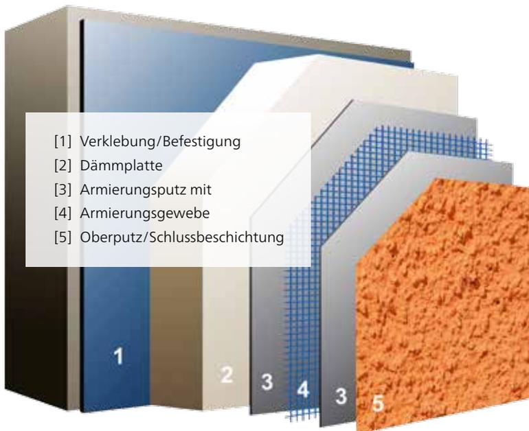
Bei klebegeeigneten Untergründen dürfen bestimmte Dämmplatten auch ausschließlich durch Verkleben befestigt werden. Einige Wärmedämm-Verbundsysteme werden mit einer geeigneten Unterkonstruktion (Schienensystem) an der Wand befestigt.
