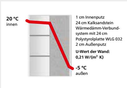
Das gesamte Mauerwerk ist „warm“, die Abkühlung erfolgt erst innerhalb der Dämmschicht. Das wird nicht nur als sehr behaglich empfunden, sondern ist auch die Garantie dafür, dass kein Schimmel entstehen kann, denn es gibt innen keine kalten Wandflächen.
