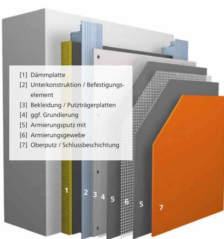
Die vorgehängte hinterlüftete Fassade ist praktisch für alle Gebäudetypen geeignet und wird sowohl im Neubau als auch in der Modernisierung eingesetzt. Der erforderliche Aufwand (Erstinvestition) ist – verglichen mit anderen Außenwandkonstruktionen – höher. Dem gegenüber stehen jedoch die lange Lebensdauer und der geringe Wartungs- und Instandhaltungsaufwand.
